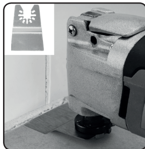
2. ábra. Ragasztó- és tömítőanyag maradványok eltávolítása kaparóval.
