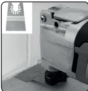
Obr.2, odstraňování zbytků lepidla či tmelů škrabkou
