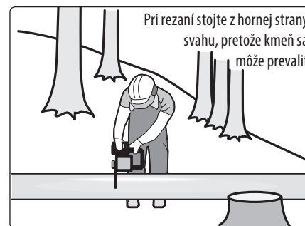
Kmeň podporený na oboch koncoch, obr. 19
